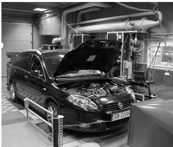
Ryc. 1. Samochód Fiat Croma 1,9 podczas badań emisji Fig. 1. Fiat Croma 1.9 during emission tests
